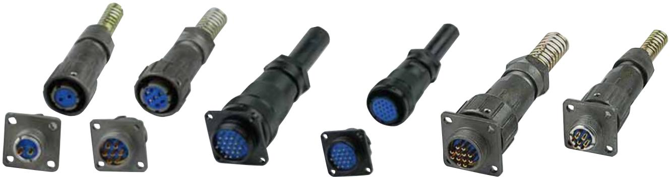
FQ 防水型系列圆形电连接器符合电子工业部元器件工业管理局批准DZ4Q/RE008-84制造，产品结构先进，可靠性高，体积小，重量轻，卡口快速连接，防水性能优良，操作使用简便。结构先进，电连接性能优良，价格低廉，性价比高。插针、插孔引线采用焊接式，产品被广泛用于各种电子仪器、电子、电气设备间有防水要求的电连接中。产品针、孔可以根据您的要求互换。
